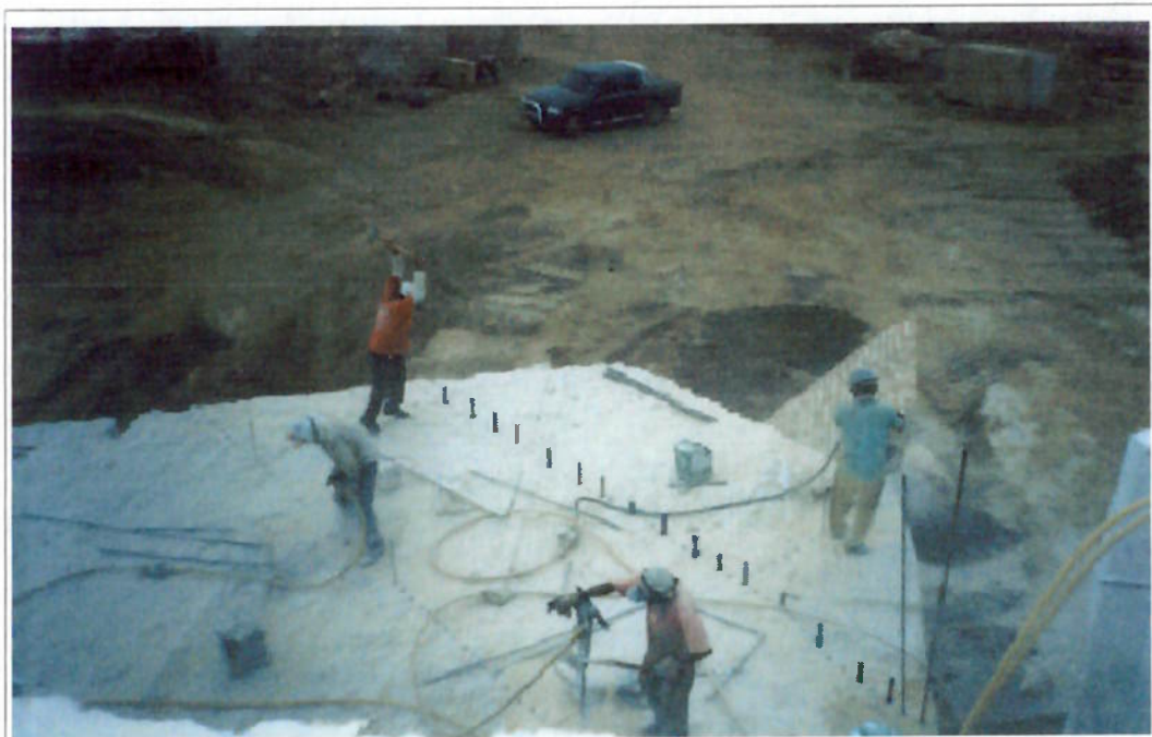
Figura 16: Utilização de cunhas metálicas para desdobramento dos blocos.
