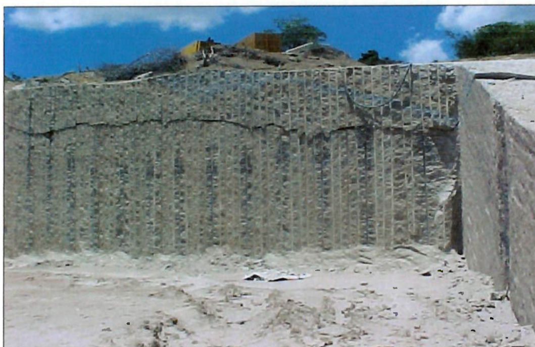
Figura 13: Para o corte frontal foi utilizado perfuratrizes e explosivo, e o para corte lateral foi utilizado “jet flame”. A trinca visível na parte frontal deve-se ao mal dimensionamento do Plano de Fogo.
