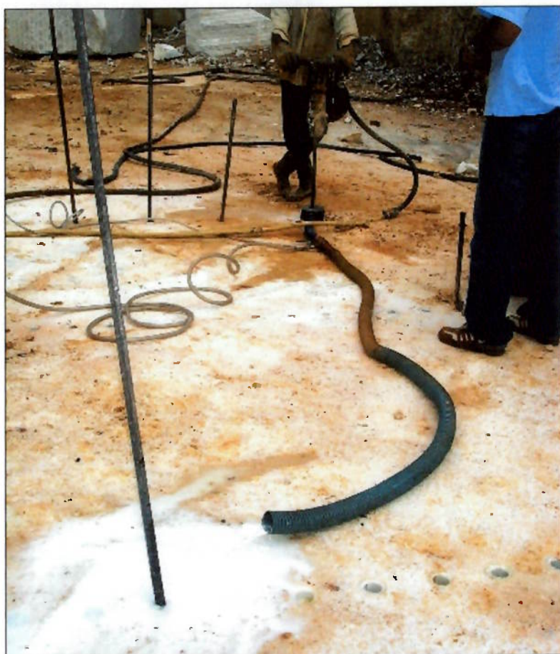
Figura 12: Eliminador de pó via úmido em operação, ressalta-se a saída da mistura de pó e água.
