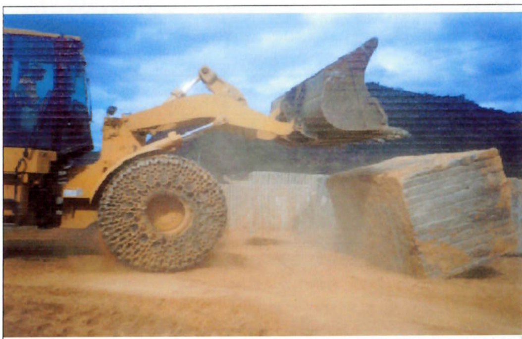
Figura 17: Carregadeira transportando o bloco através de tombamentos consecutivos.
