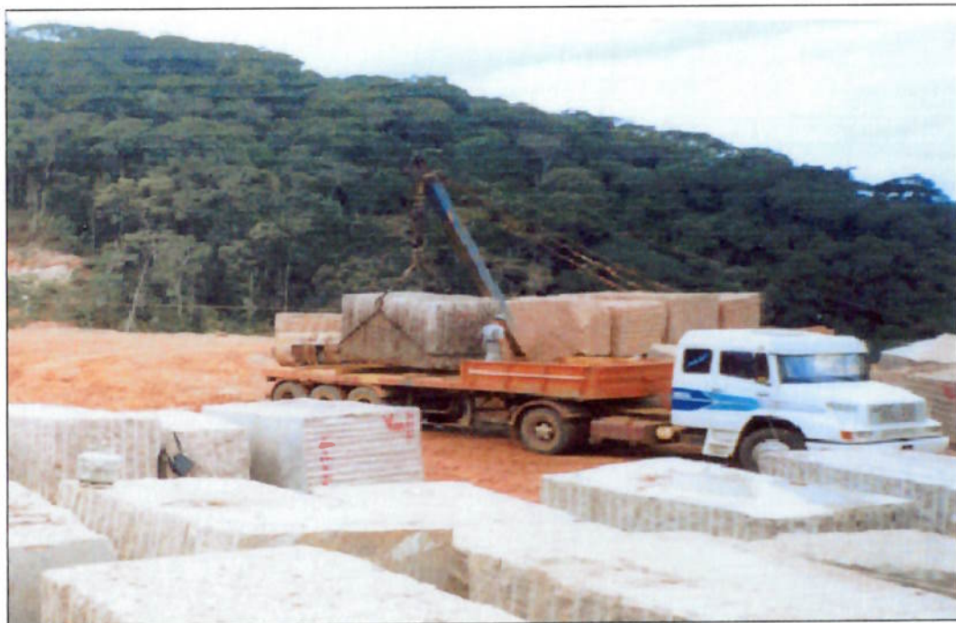
Figura 19: Carregamento do bloco em carreta, utilizando “pau de carga”.
